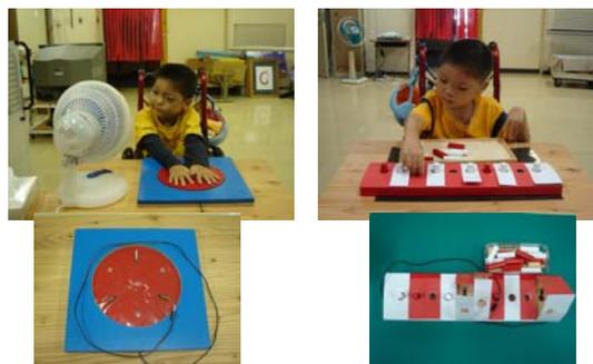
「円盤型はめ」、「リベット差し」とともに、スイッチを直列に接続し、完成するとスイッチが入るようにした。電気器具と接続して、完成した喜びをより味わえるようにした。電気器具との接続は「BDアダプター」「リレースイッチ」を利用している。
